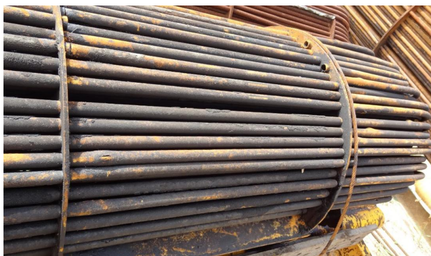
Figura 2 – Aspecto geral do feixe do permutador de teste em estudo, após a remoção do casco.
