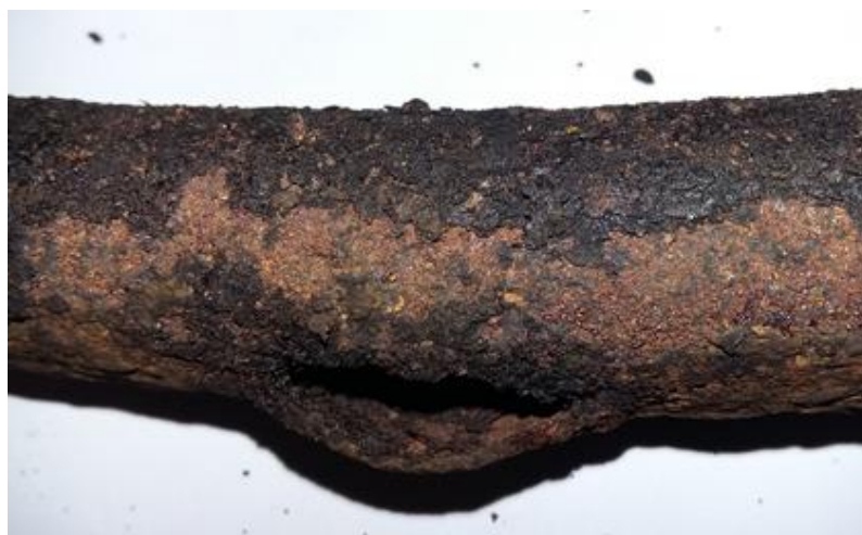
Figura 14 – Aspecto visual do resíduo aderido à superfície externa do tubo do permutador de teste.
