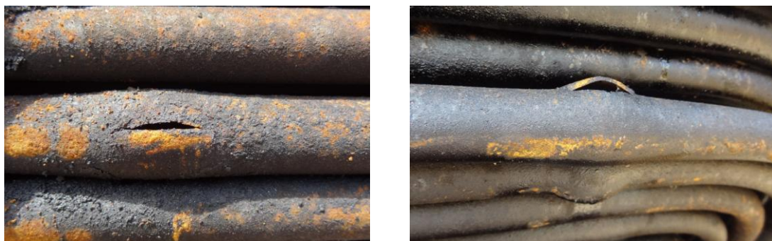
Figura 3 – Detalhe das falhas no feixe do permutador de teste após a sua remoção.
