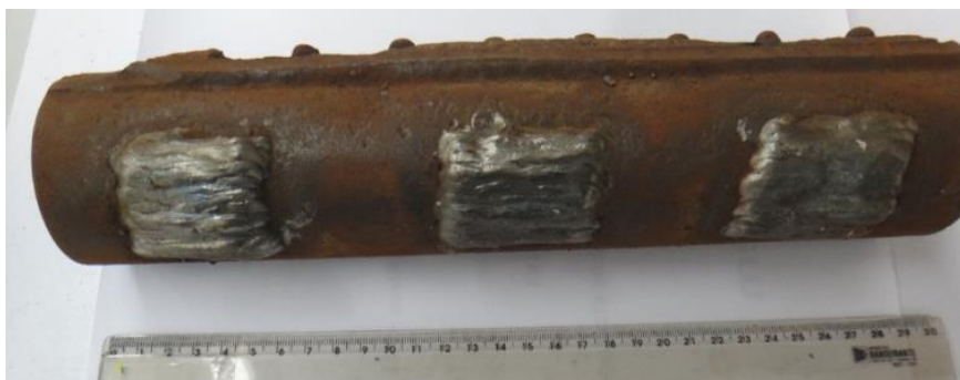
Figura 5 - Amostra 4: tubo usado da Amostra 2 que serviu de corpo de prova para fazer a reposição de espessura por soldagem.
