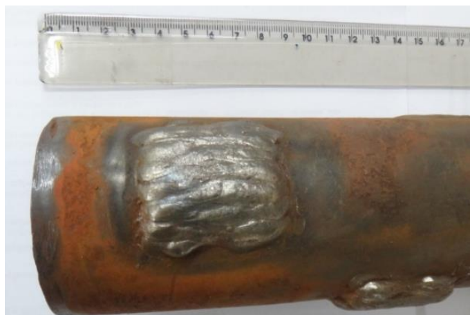
Figura 4 - Amostra 3: tubo novo da Amostra 1 que serviu de corpo de prova para fazer a reposição de espessura por soldagem.
