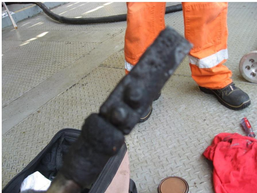
Figura 13 - depósitos formados na superfície de cupom retangular, exposto ao meio por 14 meses.
