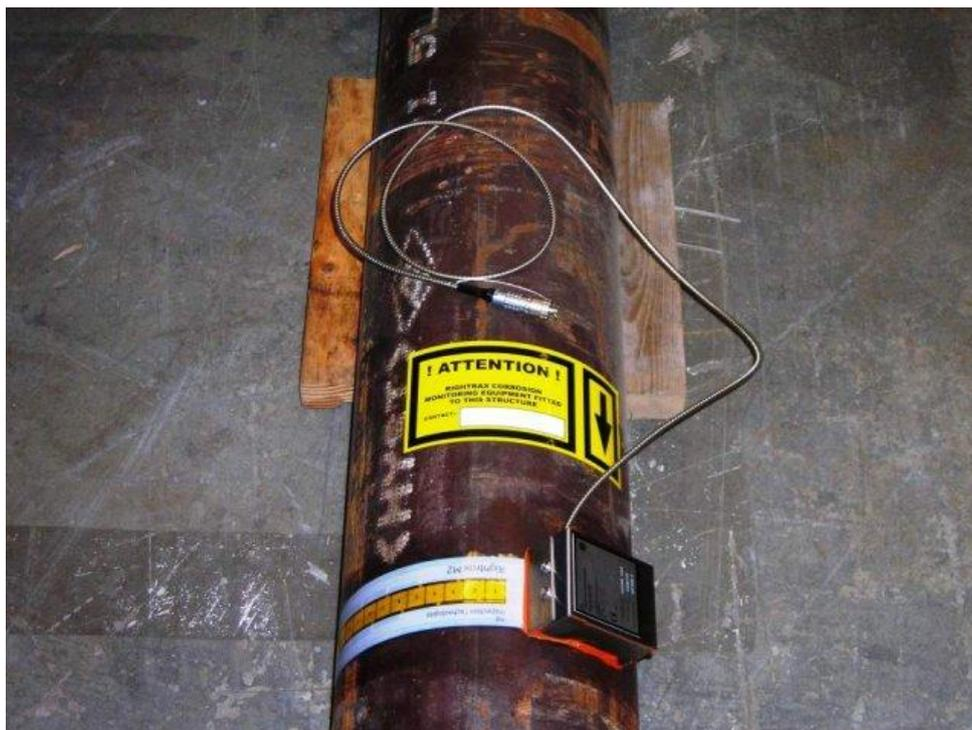
Figura 5 - instrumento baseado em tecnologia ultrassônica Rightrax, fabricado pela GE.
