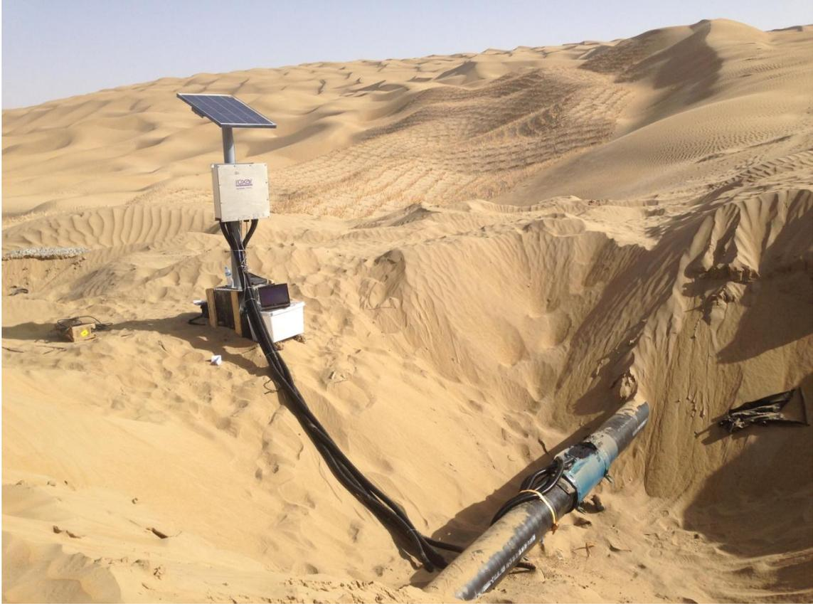
**Figura 21 - FSM instalação em local remoto, energizado através de painel solar.**
