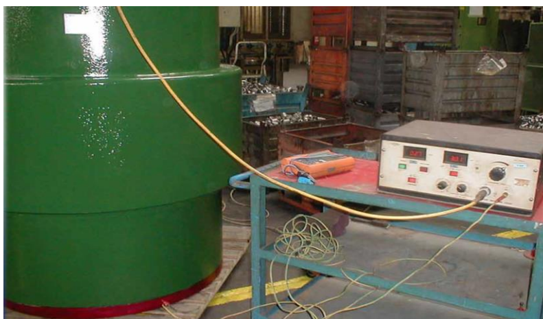
Figura 9 - Teste de Rigidez Dielétrica
