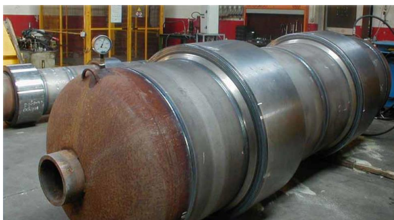
Figura 8 - Teste Hidrostático de Pressão
