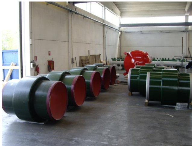
Figura 3 - Juntas de Isolamento Elétrico Monobloco (Cortesia Fabricante Nuova Giungas)
