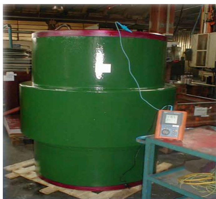
Figura 10 - Teste de isolamento Elétrico
