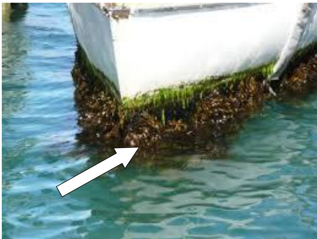
Foto 14 – Exemplo de estrutura incrustada.
