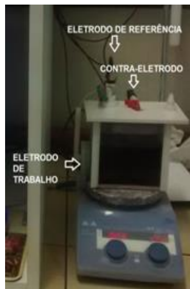
Figura 1 – Célula eletrolítica de três eletrodos, utilizada nos ensaios de eletrodeposição por corrente contínua.
