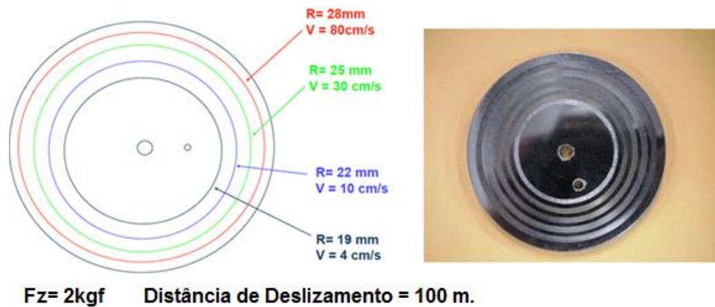
Figura 3 Representação esquemática dos parâmetros utilizados nos ensaios de pino-sobre-disco (R = raio do disco; V = Velocidade).
