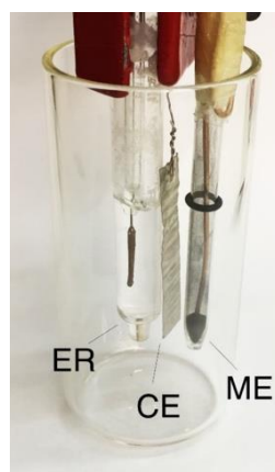
Figura 1 - Célula eletroquímica utilizada para medidas por VC dos MEs.
