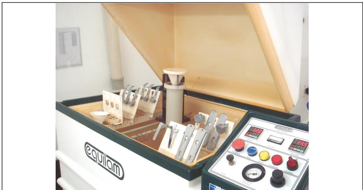
**Figura 3: Posicionamento das amostras na câmara de ensaio**
