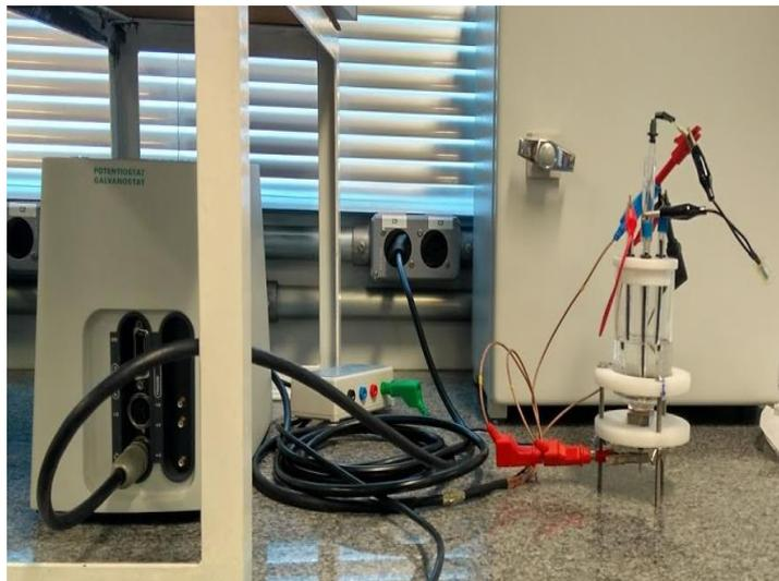
**Figura 1 - Célula eletroquímica utilizada com eletrodos e potenciostato PGSTAT204N.**
