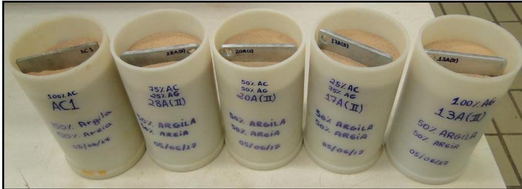
Figura 1 - Corpos de prova de aço galvanizado enterrados na célula de ensaio em solo.
