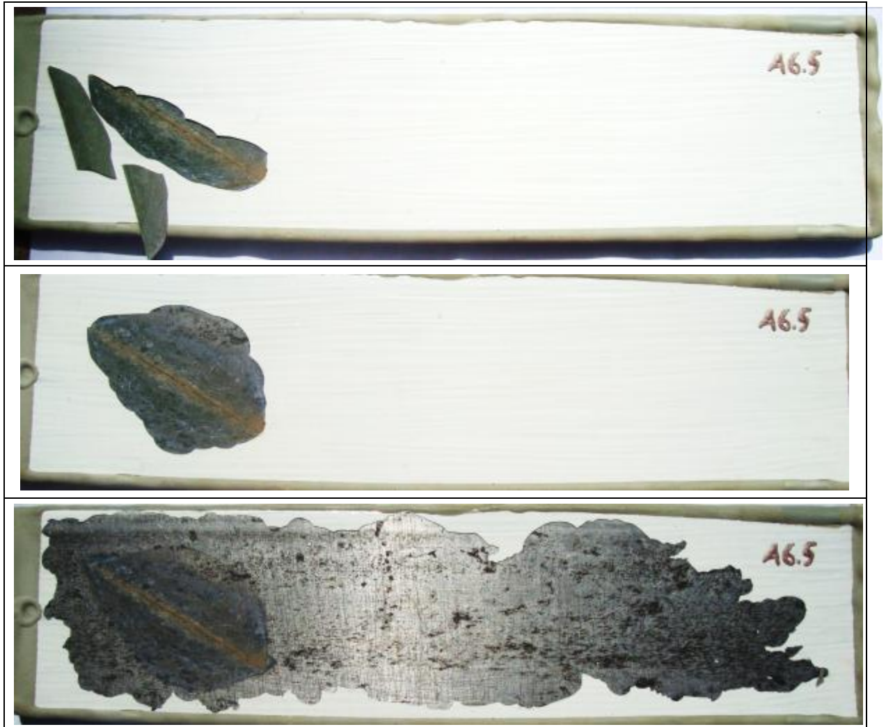
Figura 4 - Delaminação a partir da incisão em um dos corpos-de-prova com o esquema A6, evidenciando perda de aderência entre o substrato e o esquema.
