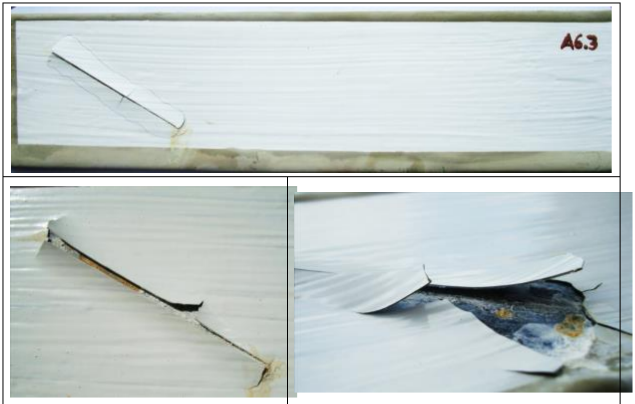
Figura 2 - Aspecto do esquema A6, após 4695 horas do ensaio cíclico de corrosão, mostrando uma intensa delaminação a partir da incisão.
