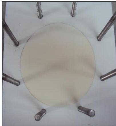
**Figura 16 – Painele #3 após 500 h de ensaio mostrando apenas variação de cor entre as fases líquida e vapor**
