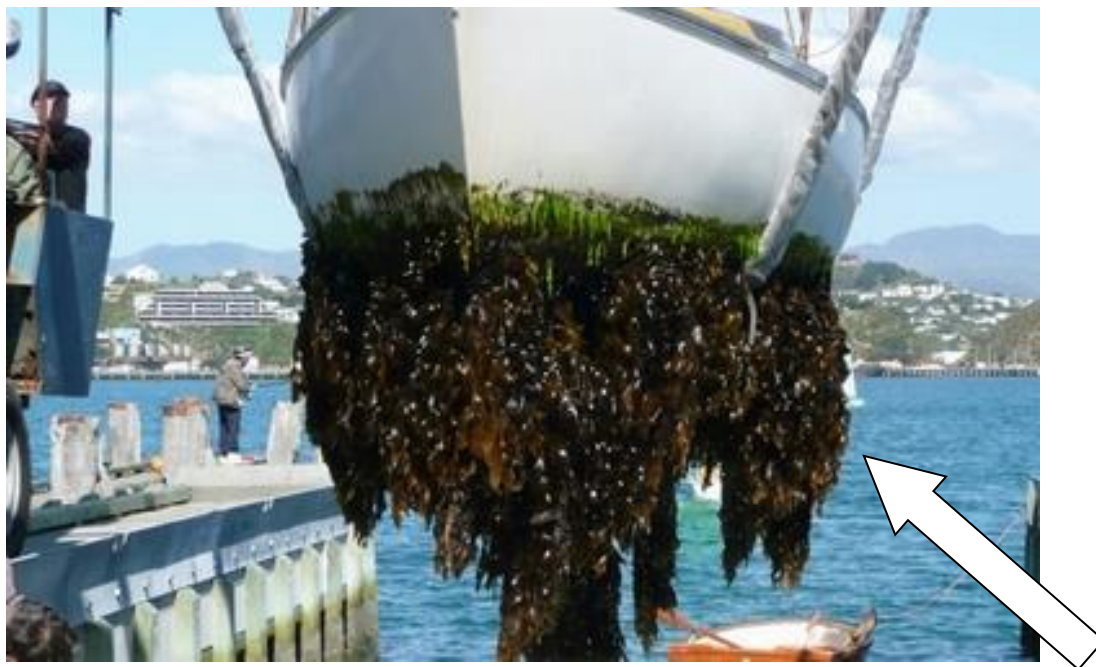
Foto 15 – Exemplo de estrutura incrustada.
