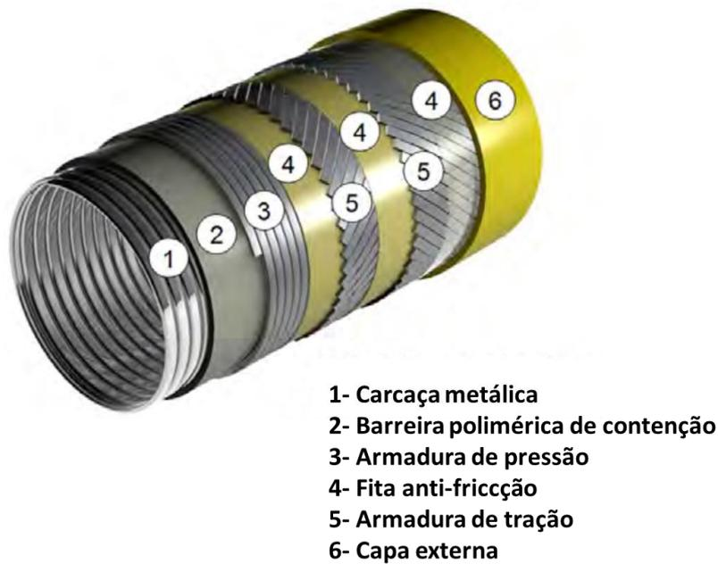
Figura 1- Estrutura típica de um duto flexível (1)
