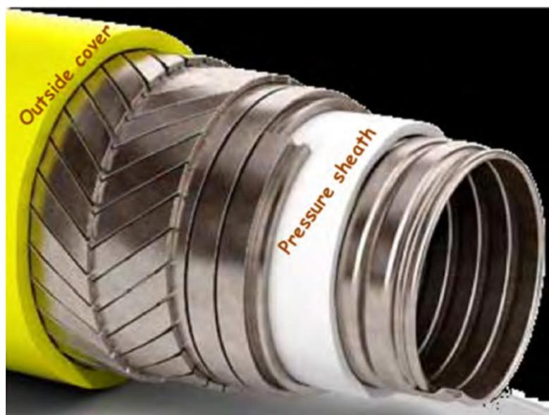
Figura 2: Corte de um flexível tipo *unbonded* com indicações das barreiras poliméricas interna (*pressure sheath*) e externa (*outside cover*) (1)
