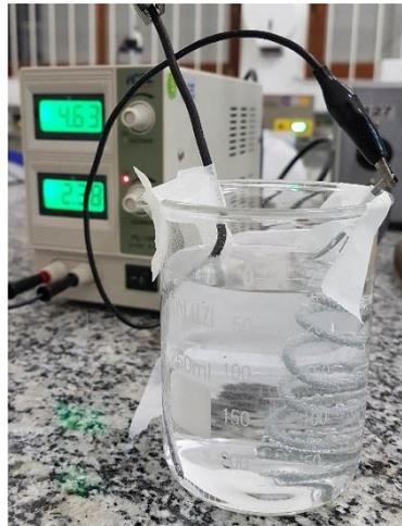
**Figura 5 - Montagem experimental para eletrodeposição do zinco**
