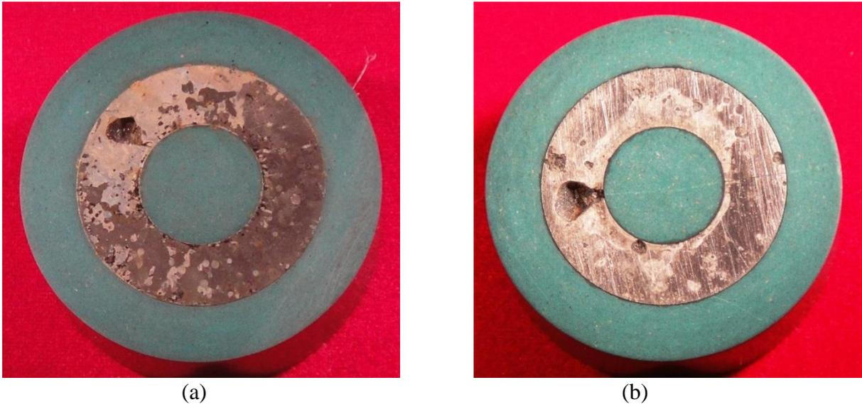
Figura 9 – Corpo de prova – (a) antes de decapar; (b) após decapagem química.
