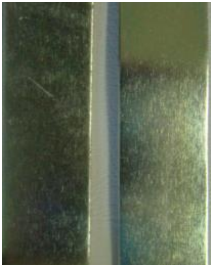
Amostra galvanizada eletroliticamente.
