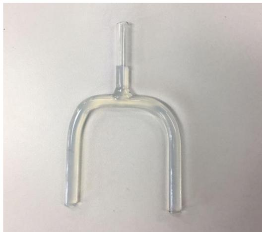
Figura 2.2 – Ponte salina pronta para uso.
