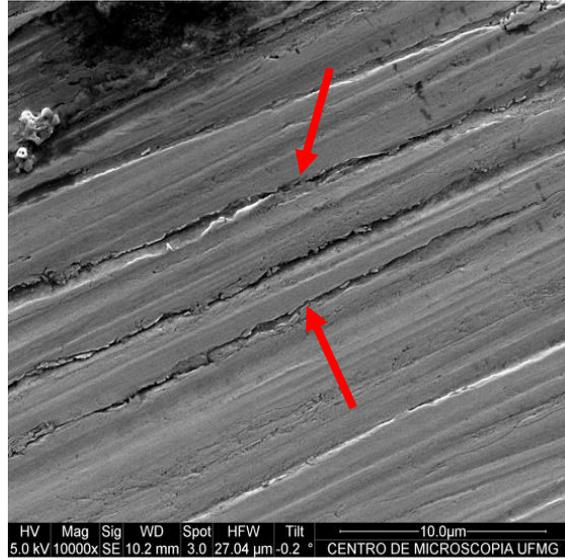
Figura 3.12 – Corrosão em amostra com LP.
