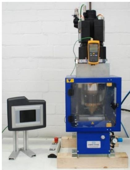
**Figura 2 - RPS100 utilizada para soldagem das amostras no presente trabalho.**
