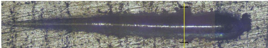
Figura 4 – Risco produzido durante o ensaio de scratch test com uma delaminação (representada pela linha amarela) observada quando a força aplicada foi de 3,824 Kg.
