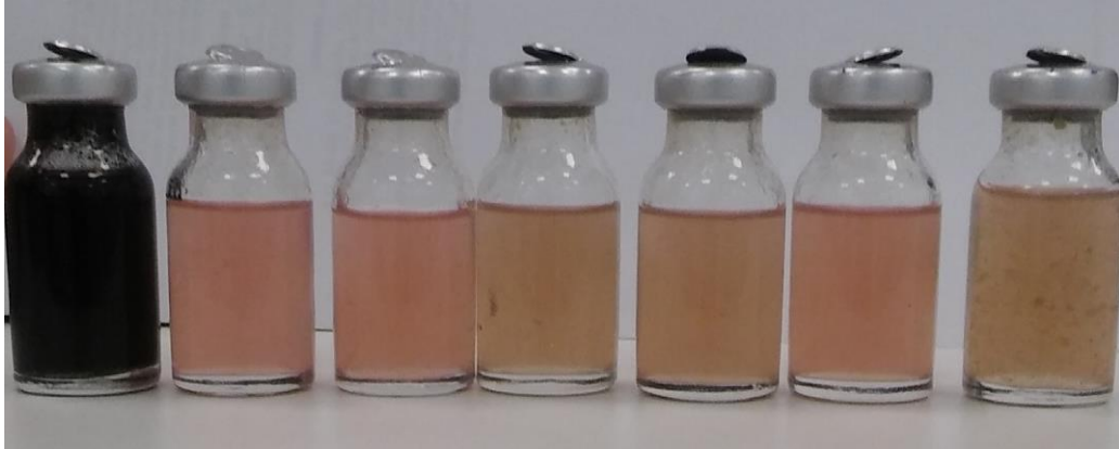
Figura 3 – Teste de desafio por CIM para o Produto 02 frente ao microrganismo Desulfotomaculum nigrificans ATCC 19998 em meio Postgate E modificado. (1º frasco: controle positivo; 2º frasco: controle negativo; 3º ao 7º frasco: teste em quintuplicata)
