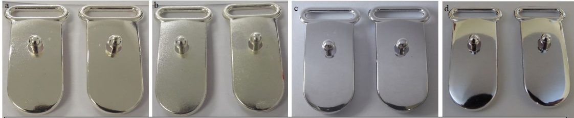
Figura 3 - Amostras a) Ag ED T b) Ag ED UV c) Al PVD UV d) Al PVD T, após ensaio de resistência ao fosqueamento, conforme ABNT NBR 14369:2012.
