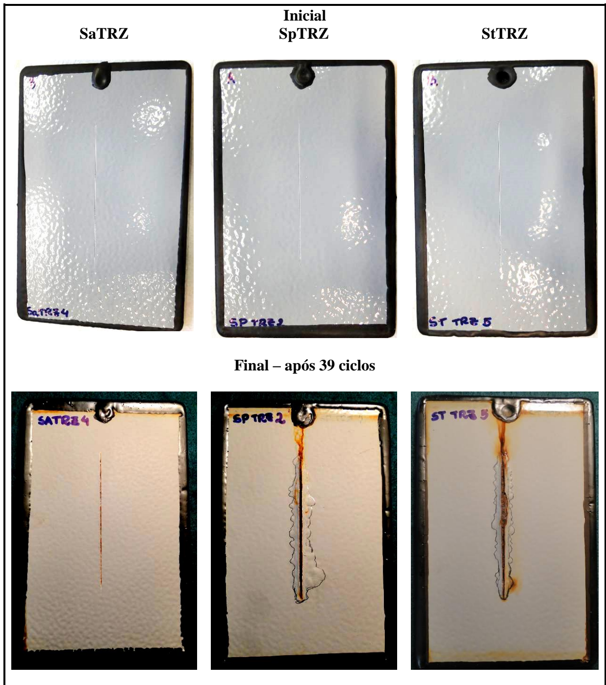
Figura 4 – Aspecto visual representativo dos corpos de prova com incisão, antes e após ensaio cíclico de corrosão atmosférica.
