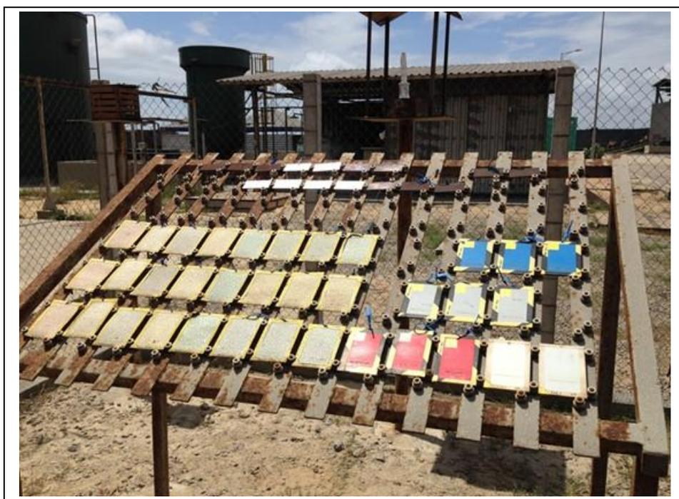
**Figura 1 – Estação de corrosão atmosférica ECA1**
