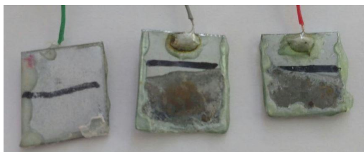
Figura 5: Configuração das amostras de aço galvanizado após ensaio em solução de sulfato de sódio e fosfato de sódio bibásico heptahidratado 3,5% p/p na temperatura ambiente.
