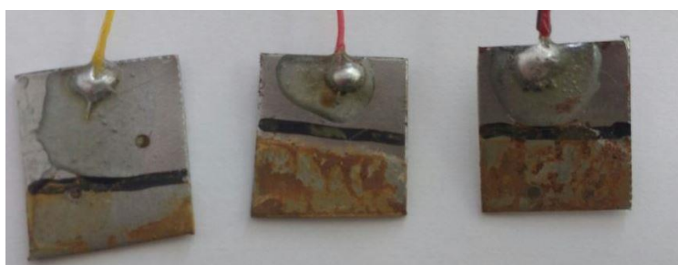
Figura 6: Configuração das amostras de aço carbono após ensaios em solução de sulfato de sódio 3,5% p/p na temperatura ambiente.
