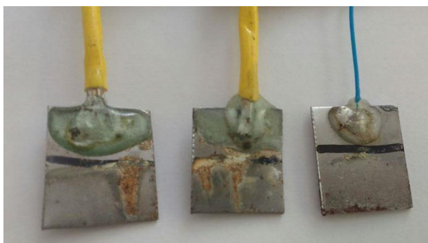
Figura 4: Configuração das amostras de aço carbono após ensaio em solução de sulfato de sódio e fosfato de sódio bibásico heptahidratado 3,5% p/p na temperatura ambiente.
