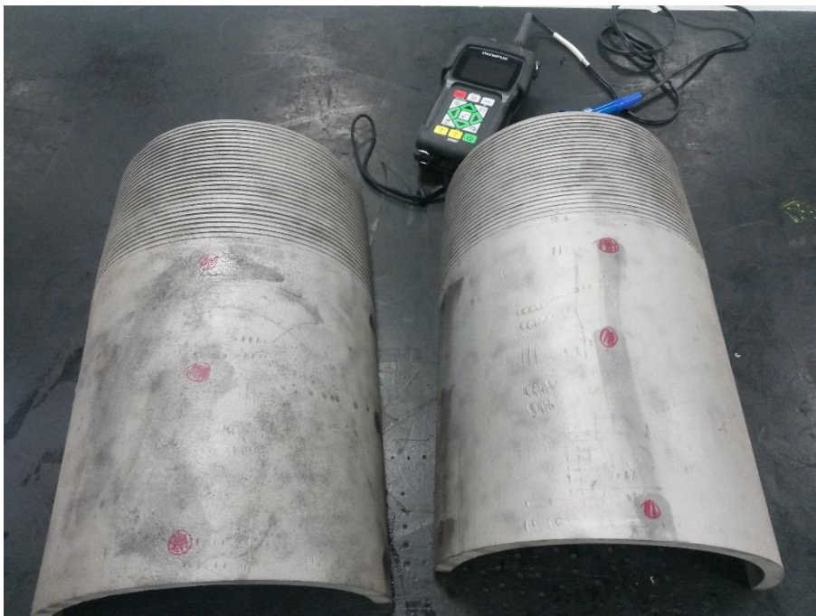
Figura 2 – Trecho do revestimento de produção imediatamente abaixo do suspensor de revestimento removido do poço.
