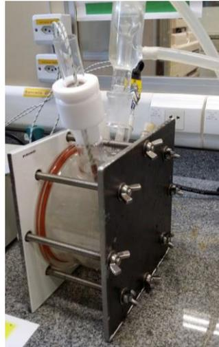
Figura 8. Célula Atlas usada para os testes de imersão
