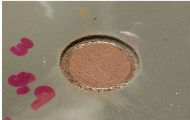
**Figura 3.** Corpo de prova sobre Sa3 com falha adesiva do tipo B/C, onde o *primer* fica exposto.
