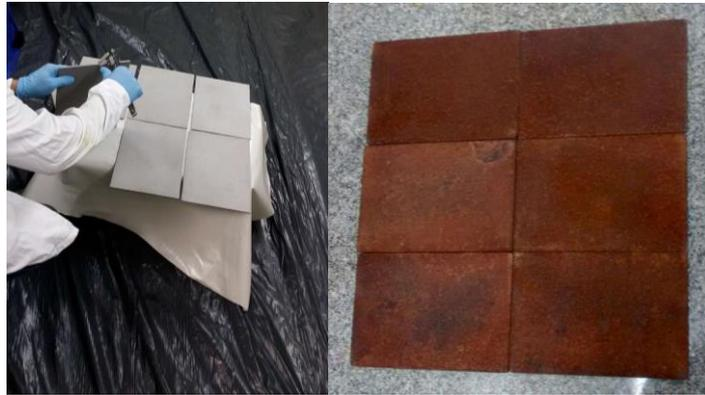
**Figura 1. Painéis de aço de 200 x 300 x 4 mm jateadas ao metal branco e painéis com grau de enferrujamento C**
