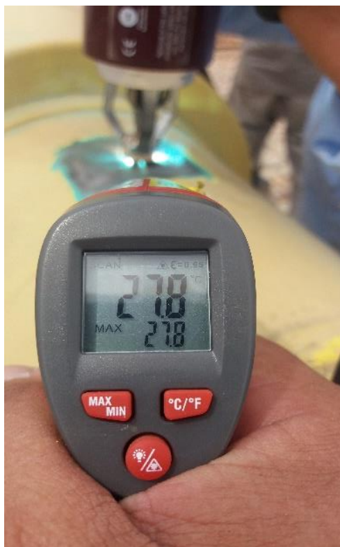
Figura 5: Temperatura na parede do duto no início do acionamento da pistola
