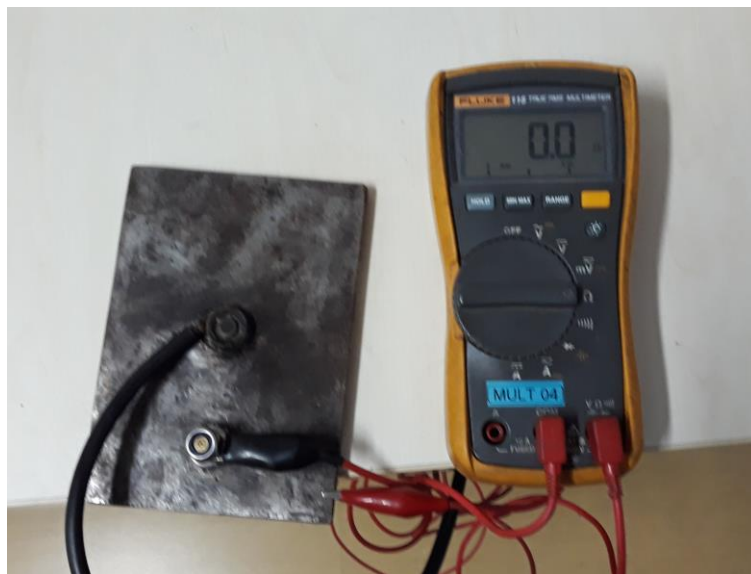
Figura 7: Ensaio da resistência elétrica
