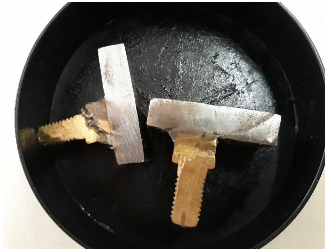
Figura 8: Corte a frio da conexão
