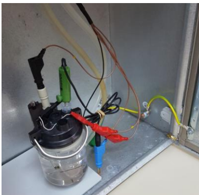
Figura 4. Célula eletroquímica usada para caracterizar os revestimentos de alumínio.
