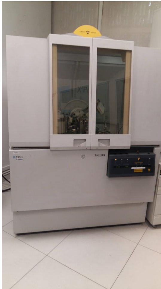
Figura 10 - Difratorômetro de raios X Philips linha X'Pert (Laboratório de Caracterização Tecnológica do Departamento de Engenharia de Minas e de Petróleo da Escola Politécnica da USP)
