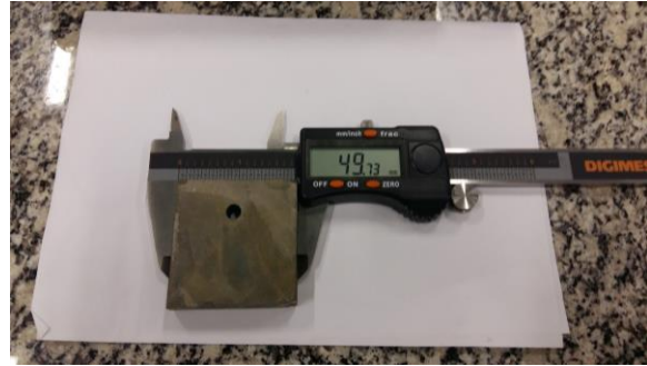
Figura 02 – Medição das dimensões geométricas das amostras, por meio de paquímetro.
