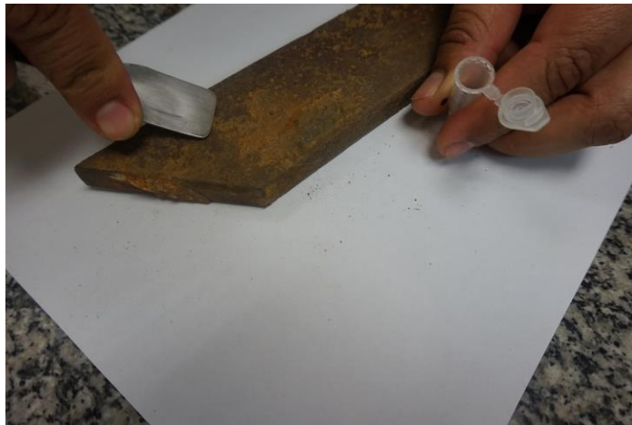
Figura 09 – Detalhe da retirada do produto de corrosão na haste metálica
