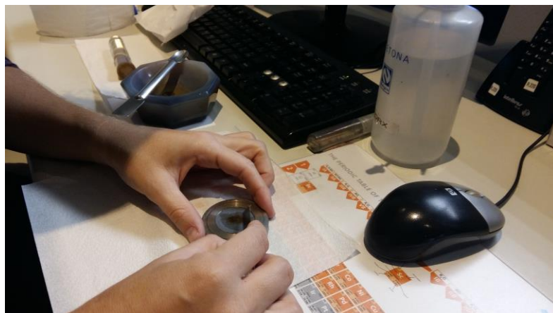
Figura 10 – Produto de corrosão sendo preparado para a realização do ensaio de Difractometria de raios X
