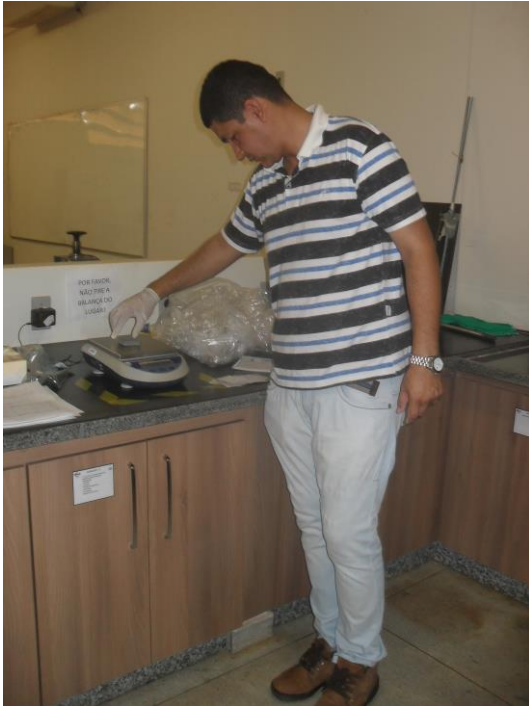
Figura 01 – Aferição da massa de cada amostra, por meio de balança.
