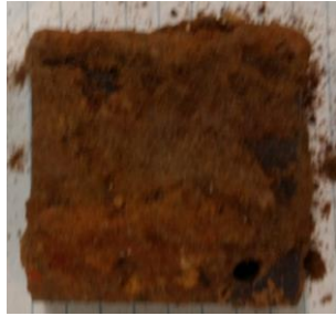
Figura 06 – Corpo de prova metálico impregnado de solo (tempo 300 d)
