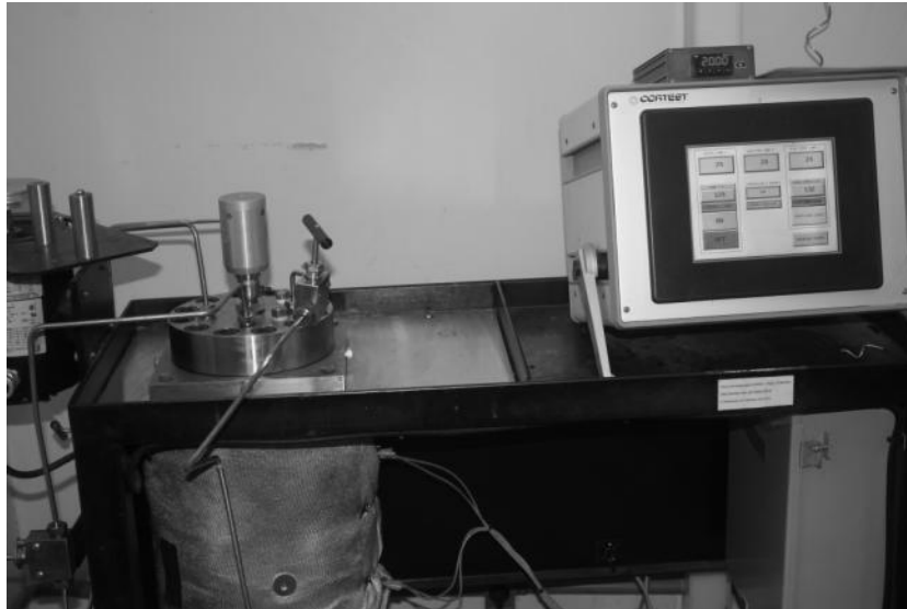
Figura 2 – Autoclave utilizada nos ensaios NACE TM0177 método D.
