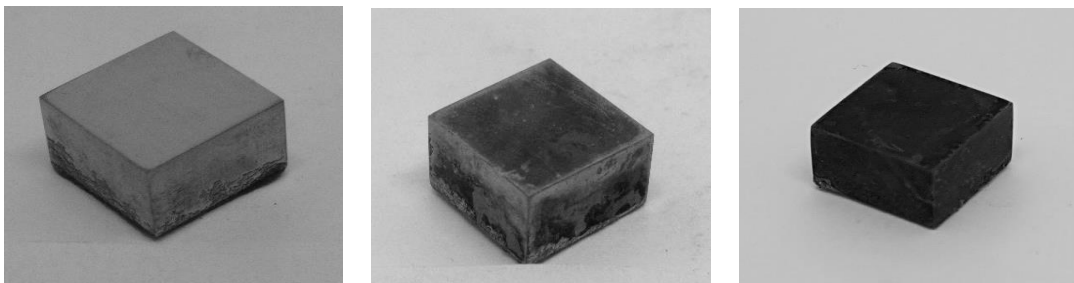
Figura 3 - Aspecto visual da formação de produto de corrosão em relação ao tempo de imersão: (a) Antes da imersão; (b) Após 1 h de imersão; (c) Após 72 h de imersão.
