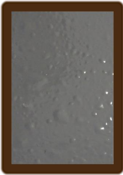
Figura 4 - Esquema IK - Imersão em água DI. Revestimento aplicado na unidade da Vale em São Luís. Grau de empolamento 4(S5).
