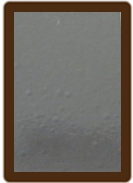
Figura 11 - Esquema IK - Ensaio de imersão em água do mar sintética. Corpos de prova preparados na unidade de São Luís. Grau de empolamento 2(S5).
