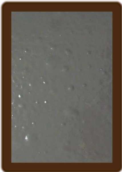
Figura 12 - Esquema EH - Imersão em água do mar sintética. Corpos de prova preparados na unidade de São Luís. Grau de empolamento 3(S5).
