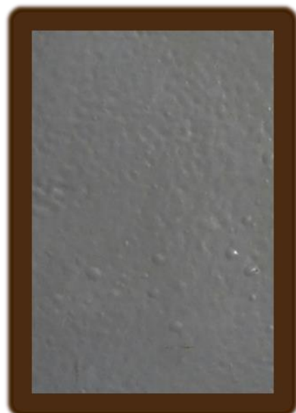
Figura 13 - Esquema GH - Imersão em água do mar sintética. Corpos de prova preparados na unidade de São Luís. Grau de empolamento 2(S4).
