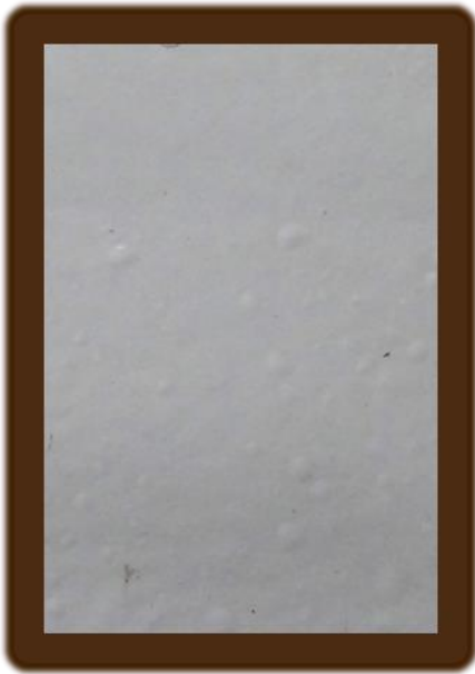
Figura 10 - Esquema JK - Ensaio de imersão em água do mar sintética. Corpos de prova preparados na unidade de São Luís. Grau de empolamento 2(S5).
