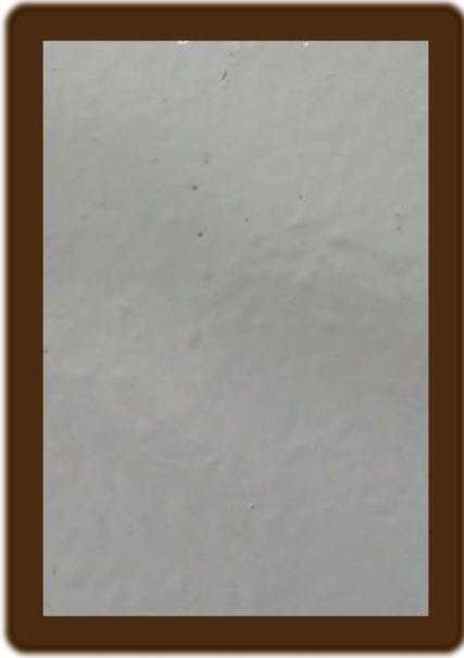
Figura 15 - Esquema AD - Imersão em água do mar sintética. Corpos de prova preparados na unidade de São Luís. Grau de empolamento 4(S4).
