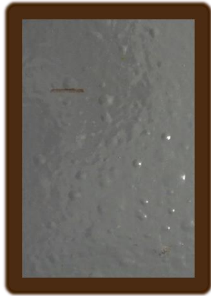
Figura 5 - Esquema EH - Imersão em água DI. Revestimento aplicado na unidade da Vale em São Luís. Grau de empolamento 3(S5).
